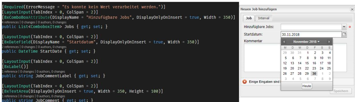
Abbildung 4.2: Beispiel für die automatische Generierung von UI-Controls
